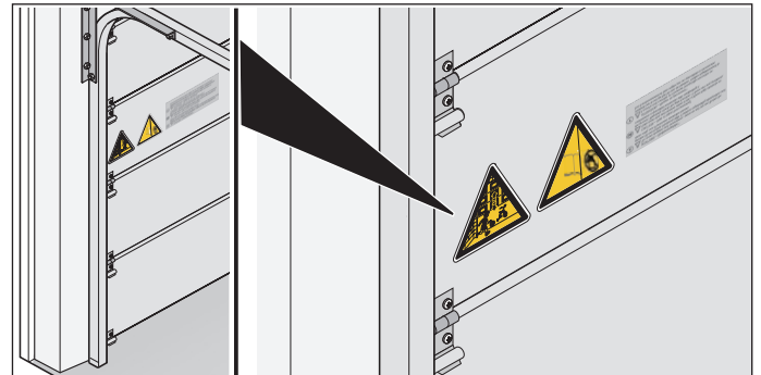
Afb. 1.2 Sticker op deurblad aanbrengen
