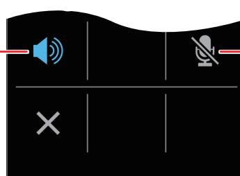
Druk op deze toets om de microfoon van het apparaat in of uit te schakelen.
