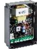
AS05870 BE24 Elektronische besturing voor 1 of 2 openers met ingebouwde ontvangerprint 433 MHz
