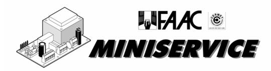
MINISERVICE is een externe schakelprint voor een ontvanger en een voeding. Hiermee heeft men de keuze tussen 24 V DC en 11 & 24 V AC. Ze kan worden gebruikt voor de voeding van bijkomende toebehoren en is ideaal voor de sturing van elektrische sloten.
