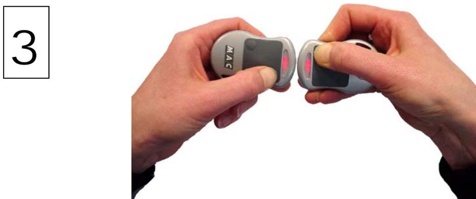
Mettez le **nouvel émetteur** avec la LED contre la LED de l'émetteur programmé (voir fig.), et appuyez sur le bouton à programmer du nouvel émetteur.
