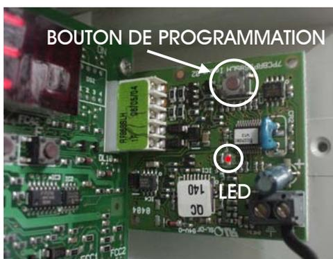
Mettez le récepteur en mode d'apprentissage en appuyant sur le bouton de programmation **et maintenir**
