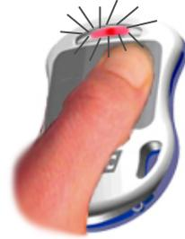
Druk nu terwijl de LED knippert **binnen de 10 sec.** op de knop van het kanaal dat u wenst in te leren (in dit geval **P1**) en houd deze ingedrukt.
