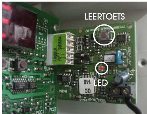
Plaats de ontvanger in leermodus door de **leertoets** van de ontvanger **blijvend** in te drukken.
