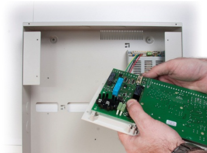
Plaats de Loopdriver print aan de achterzijde van het bedieningspaneel
