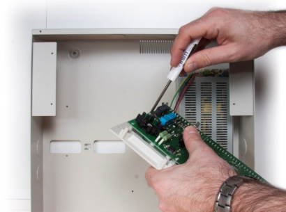
Schroef de loopdriver vast met de bijgeleverde schroefjes
