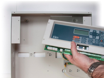
Plaats het bedieningspaneel weer terug in de behuizing
