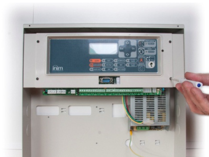
Schroef de behuizing weer vast met de schroefjes
