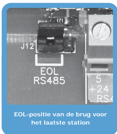
Afbeelding 27 - Kaart SmartLevel - positie van de jumper
