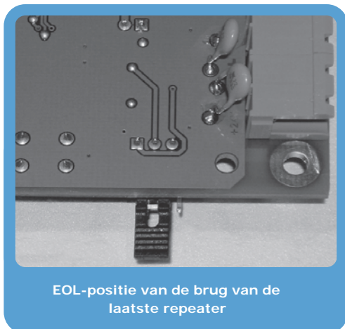
Afbeelding 26 - Kaart SmartLetUSee/LCD-Lite - positie van de jumper
