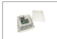
B71/PBX24/BOX Hybride inverter versie "Network Assisted" voor de voeding van de automatisering met functie van batterijlader via de aansluiting van zonnepanelen of vast stroomnet voor de voeding van de digitale controllers Brushless 24V DC met netspanning van 230V AC.
